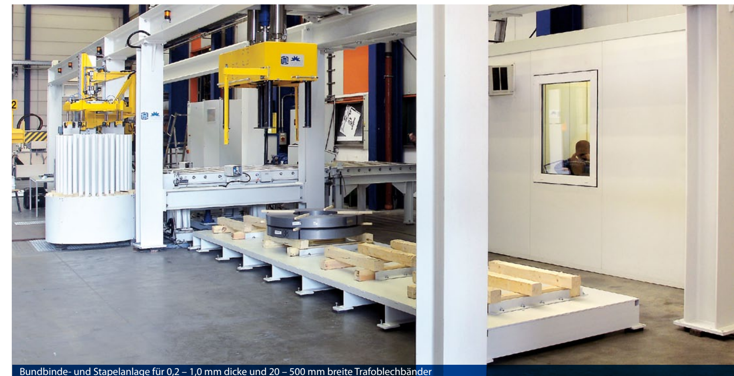
Bundbinde- und Stapelanlage für 0,2 – 1,0 mm dicke und 20 – 500 mm breite Trafoblechbänder
