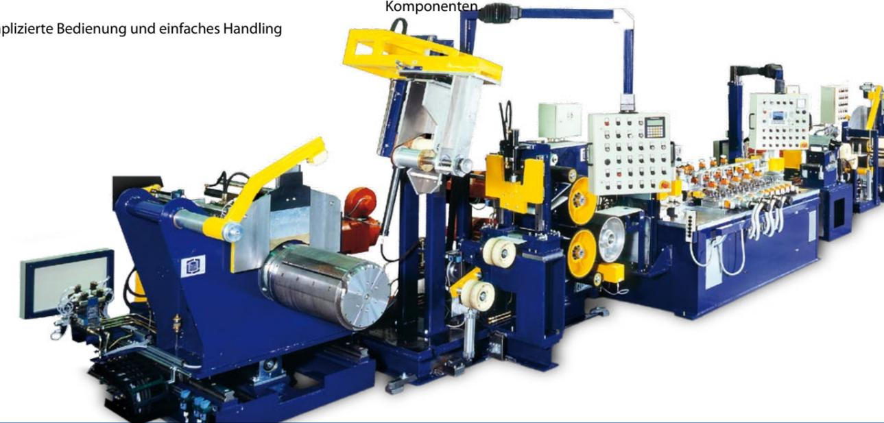
Bandkantenbearbeitungsanlage mit manueller und motorisch betriebener Werkzeuganstellung
