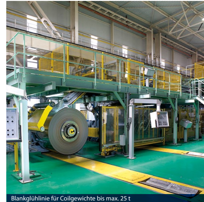
Blankglühlinie für Coilgewichte bis max. 25 t
